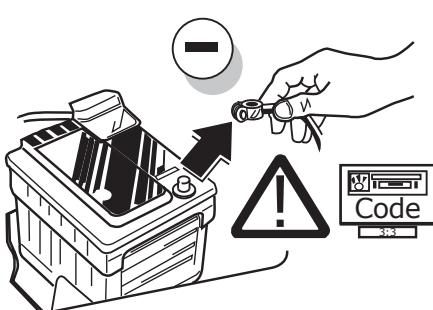
**DE** Um Störungen und Schäden am Bordnetz zu vermeiden, muss die Massepolklemme unbedingt vor Beginn aller Arbeiten von der Fahrzeugbatterie getrennt werden! Insbesondere bei Arbeiten und Anschlüssen am CAN-Datenbus kann bei nicht abgeklemmter Batterie sowohl das Anhängermodul als auch das fahrzeugeitige Bordnetzsteuergerät beschädigt werden! Bitte Herstellervorschriften beim Ab- und Anklemmen der Fahrzeugbatterie beachten!
